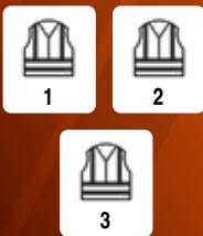
La norma especifica los requisitos de las prendas de alta visibilidad que señalan visualmente la presencia del usuario tanto a la luz del día como en condiciones de iluminación artificial por la noche. La visibilidad se garantiza mediante la combinación de un tejido base fluorescente durante el día y un tejido reflectante durante la oscuridad, lo que permite clasificar las prendas en 3 clases de protección
